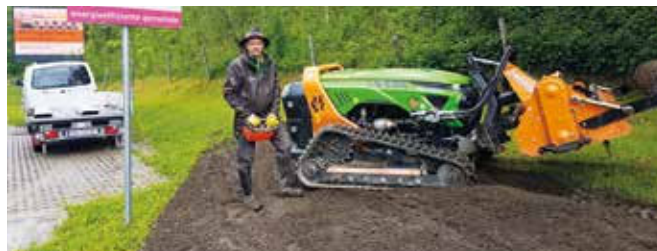
Dienstleister Hermann Steger mit seinem ferngesteuerten GreenClimber mit angebaute Umkehrfräsenauflauf im Bereich der Abfahrt Liechtensteinklamm bei der Anlage einer Bienenwiese
