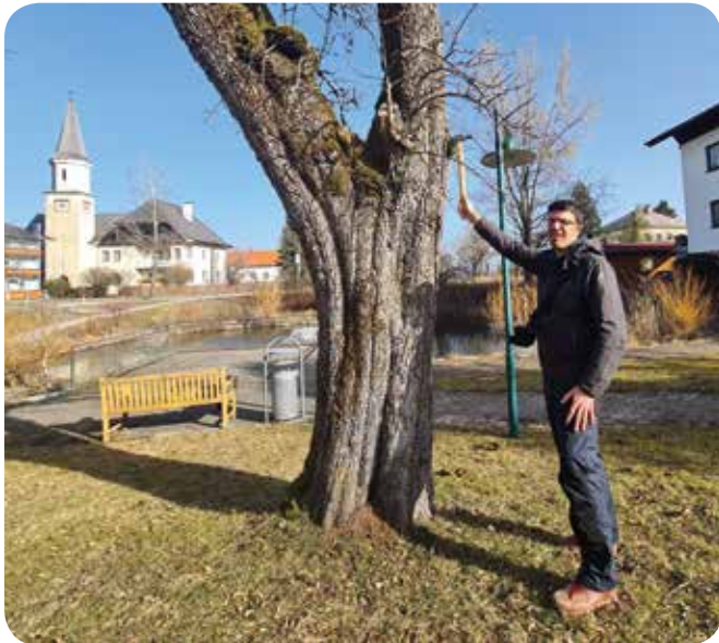
DI Maximilian Schreder beim Erfassen von Baumdaten in der Gemeinde Hof: „Mittels unserer eigenen GPS-Antenne können wir die Position von Bäumen zentimetergenau erfassen. Das ist zum Beispiel auch bei Grenzbäumen für die Baumeigentümer sehr hilfreich.“
